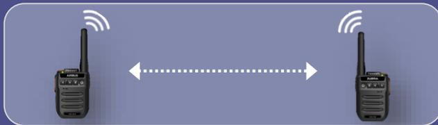
A l'instar du mode direct des terminaux ANTARES, le mode direct du RRF permet la liaison de poste à poste sans passer par le réseau. Ces communications sont possibles à travers une poire Bluetooth ou filaire, couplées à un terminal RRF
