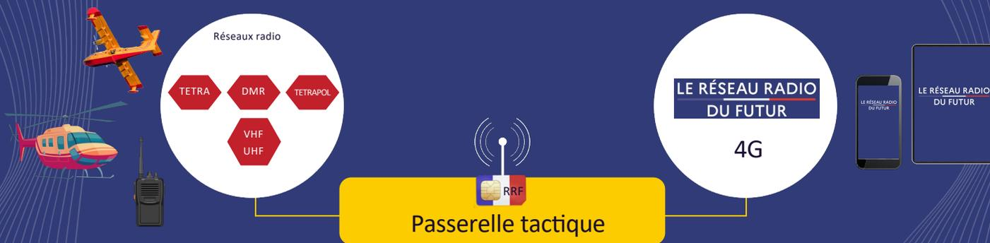
La configuration se fait via smartphone ou navigateur web, et le raccordement au datacentre RRF par modem 4G/5G.
